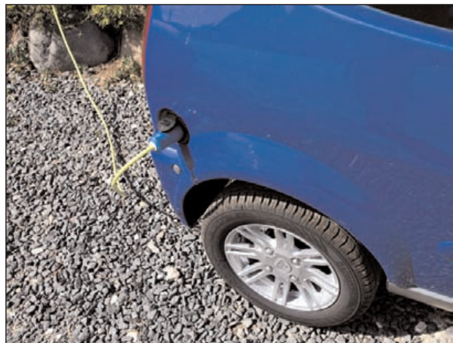
El-bilen Mega City kan køre 80 kilometer på en opladning, og en fuld opladning i en ganske almindelig 220 volt stikkontakt tager ni timer.
